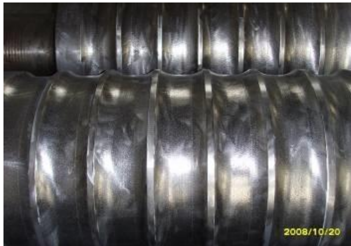
高速线材轧辊激光处理后形貌
