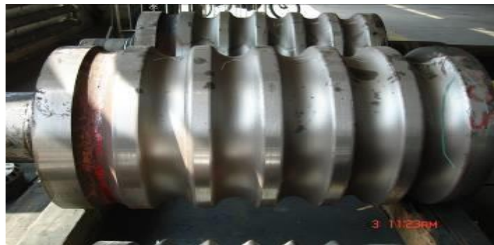
螺纹钢中轧辊原始形貌
