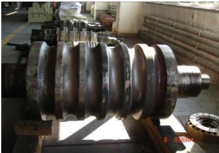
高速线材轧辊原始形貌
